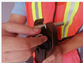
4. Coloque la pestaña de la conexión que contiene al o-ring en la ranura central de la garra (mordaza) o-ring y tener fugas.
